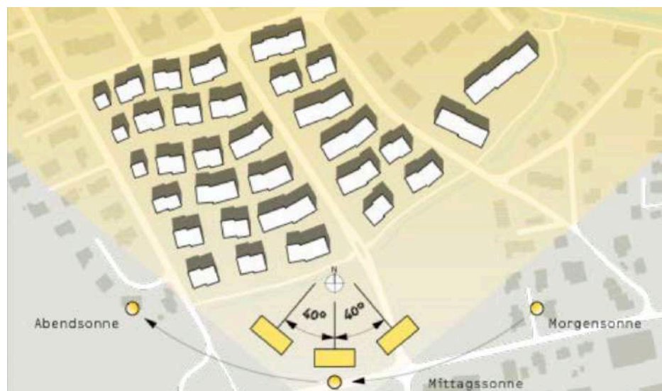
Ausrichtung der Baukörper (Quelle: Planungsbericht Bebauungsplan Zimel Art. 47 RPV vom 16.12.2015)
