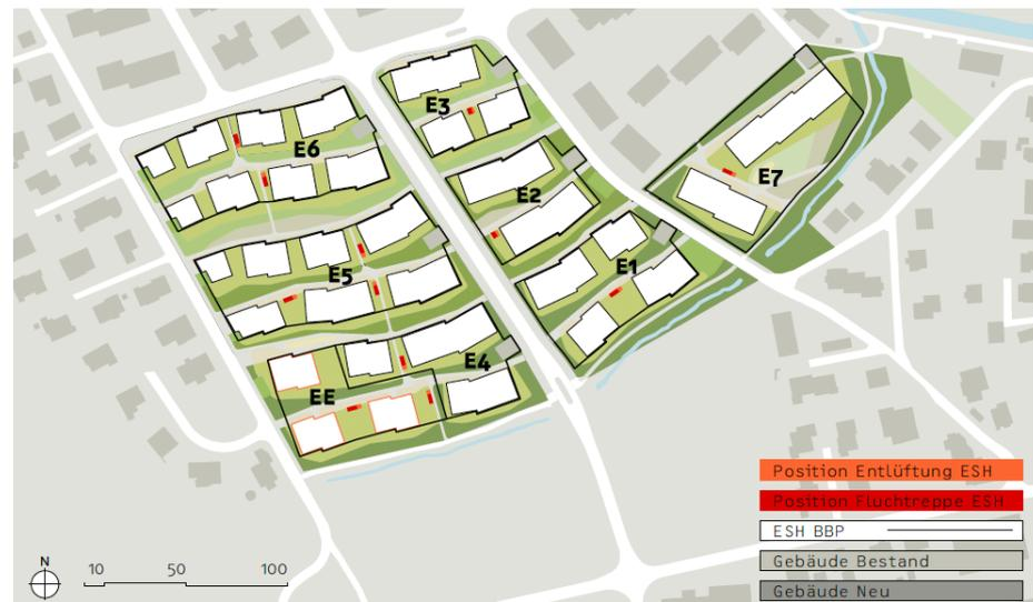
Funktionsskizze mit möglicher Position von Fluchttreppe und Entlüftung der Einstellhallen (Quelle: Planungsbericht Bebauungsplan Zimel Art. 47 RPV vom 16.12.2015)
