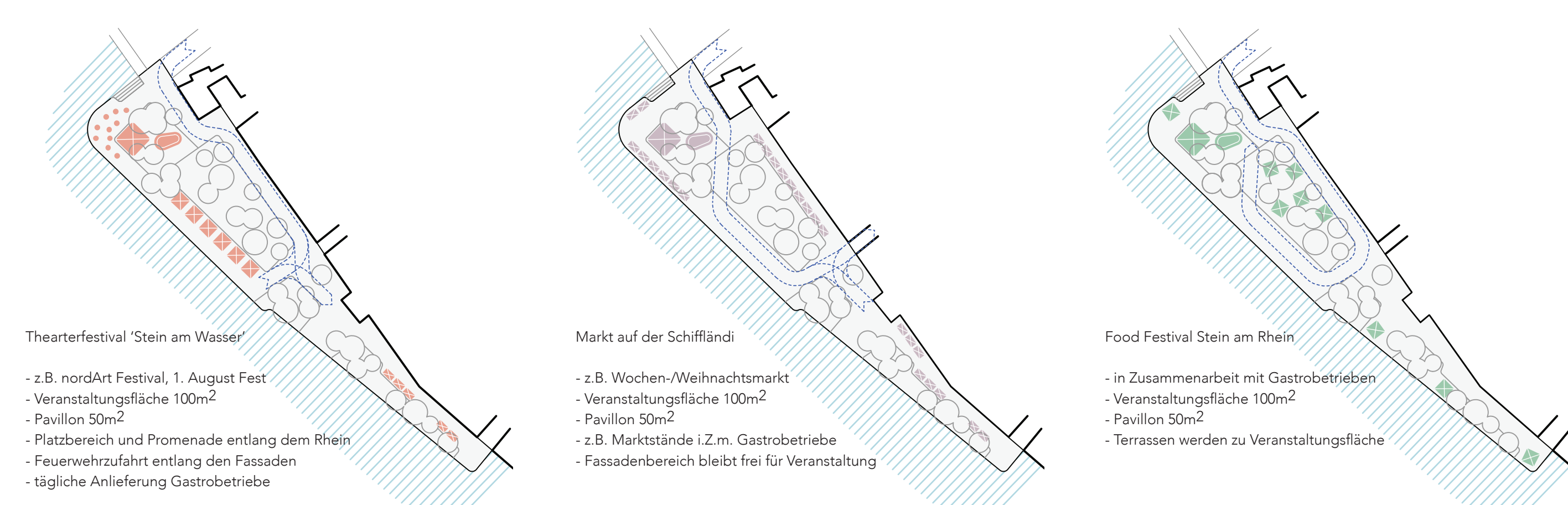
Schema Veranstaltungen & Feuerwehruzufahrten (Fahrspurbreite 5m, Kurvenausseradius 10.5m)
