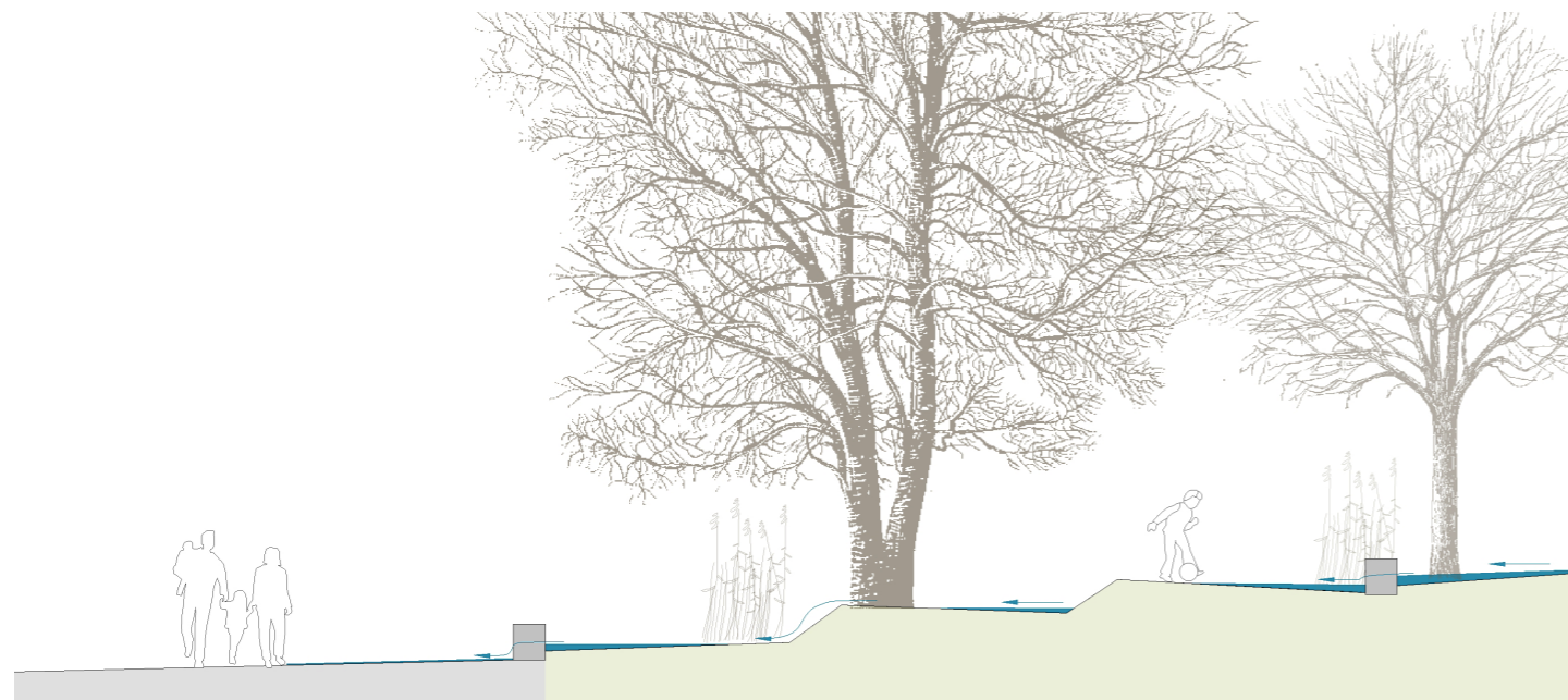
Retention und Versickerung begrünte Stufen
