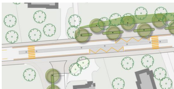
Abbildung 3-14: Mehrzweckstreifen mit gestalteter Mittelinsel bei FG-Streifen
