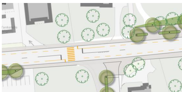
Abbildung 3-16: Fussgängerübergang mit LSA ohne Mittelinsel
