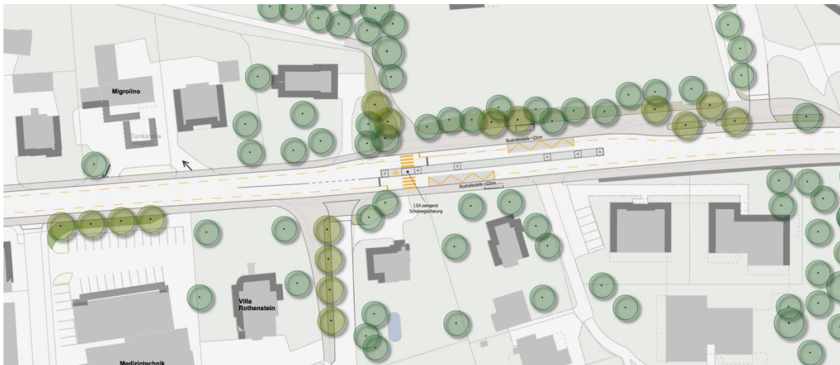
Abbildung 4-15: Kernfahrbahn mit Mehrzweckstreifen
