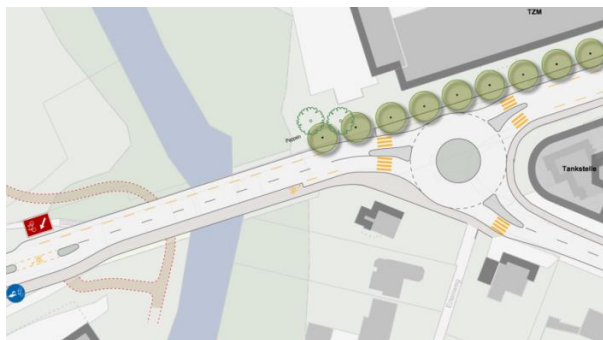
Abbildung 3-18: Kreisel (26 m) mit Veloführung im Kreisel
